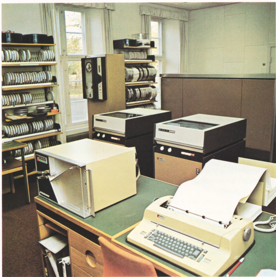
Interiør fra instituttets maskinstue for RC 4000. En del af centralenheden ses i baggrunden, foran denne de to pladelagre, ved vinduet magnetbåndsstationen og i forgrunden kontrollbordet med læser og skrivemaskine.
